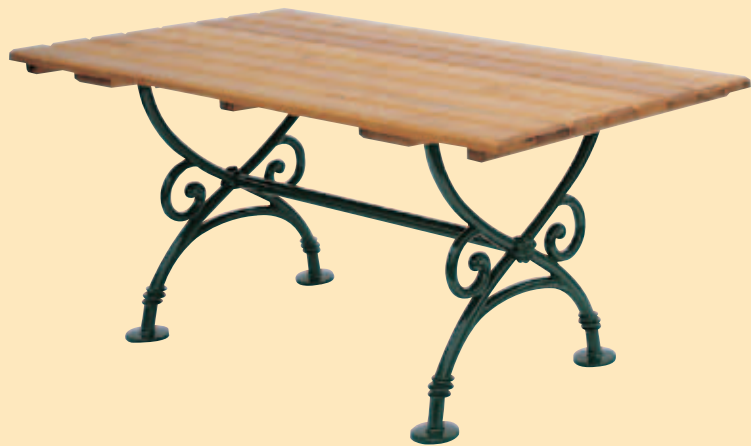
Tisch: Art. 6142 FüÙe Aluminiumguss, Verbindungsstange Aluminium, pulverbeschichtet, Farbe nach RAL, Schrauben Edelstahl, Tischplatte aus acht Brettern Akazienholz unbehandelt, L 1600 x B 845 mm, Tischhöhe: 680 mm
